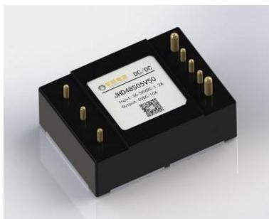
JHD48S05V50 系列是一款标准 1/16 砖系列模块电源，以超宽的输入范围（18~75V）和高效率，高功率密度、高可靠性为主要特点，输出电压 5V，功率 50W。具备输入过欠压保护、输出过压保护、过温保护、输出过流短路保护等功能。
